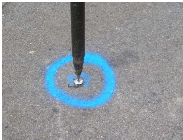
Slika 2. Stabilizacija GNSS točke na asfaltnoj površini: metalni klin (bolcna).
